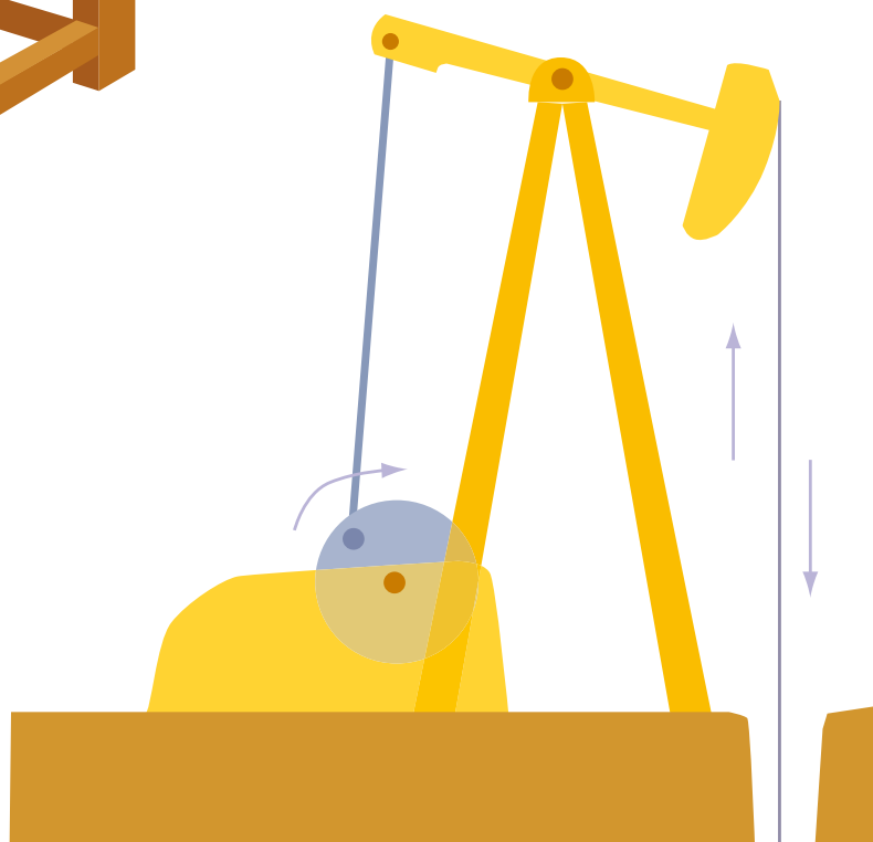
Document 2 Pompe à balancier d'un puits de pétrole, actionnée par un moteur
