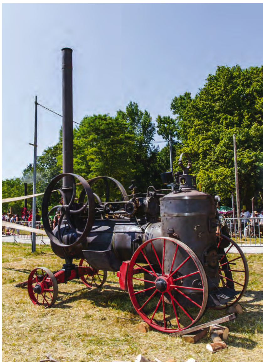
Document 2 : Locomobile à vapeur capable d'entraîner un engin agricole
